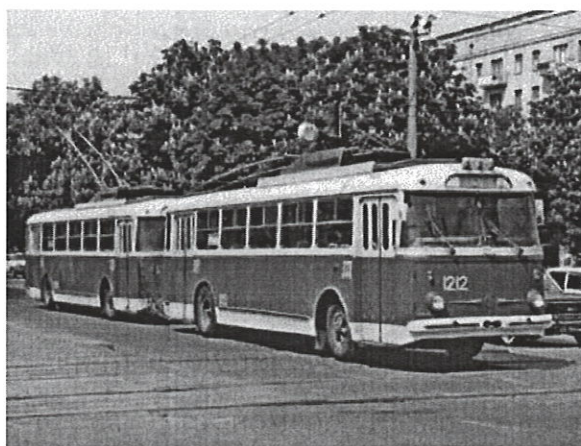
Рис. 2.5 Поїзд з тролейбусів Шкода 9 Тр, з'єднаних за системою Володимира Веклича (1982 рік)
