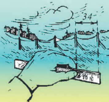
Рис. 2. Вимірювання вертикального і горизонтального кутів за допомогою лінійки Рис. 1. Вимірювання кута біноклем
